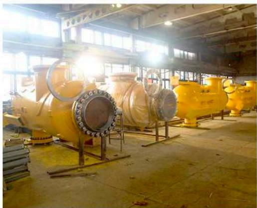
**Газовый сепаратор - центробежно-вихревой сепаратор газа СЦВ-8Г-1400/40-5975.**
