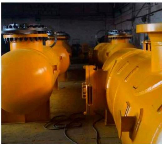
Фильтр сепаратор - центробежно вихревой
