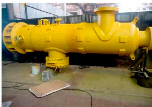
**Газовый сепаратор - центробежно-вихревой сепаратор газа СЦВ-8Г-800/100-9480.**
